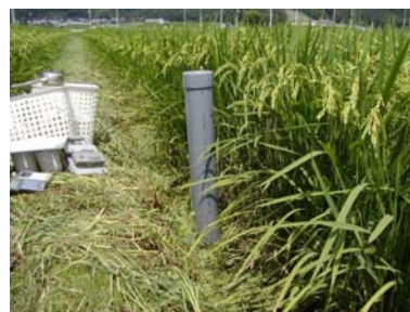
地下水パイプ (深さ約2m, ストレーナ1.7-2m)
