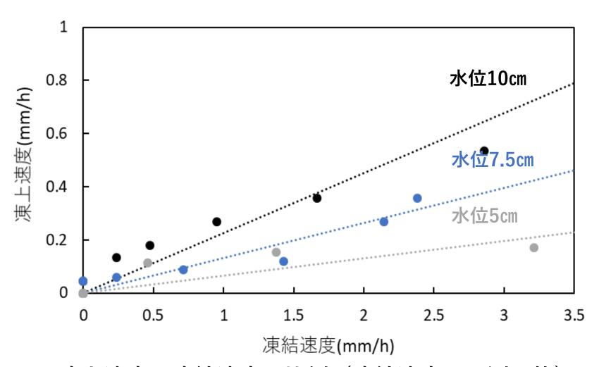
凍上速度は凍結速度に比例(凍結速度で予測可能) 水位が低くなっても比例、傾きは小さくなる
