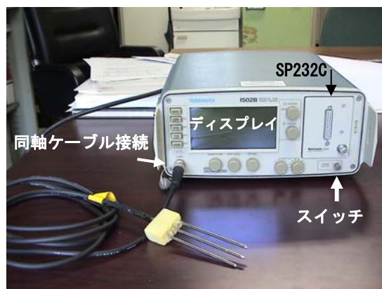
図1 ケーブルテスターと TDR プローブ
