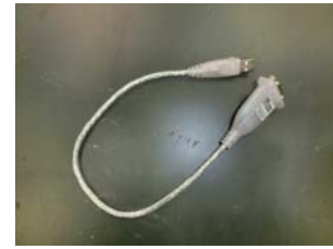
ロ ガ ー ポート PC シリアルポート RS232C ケーブル シリアル-USB 変換ケーブル
