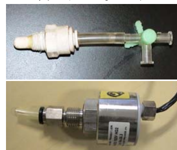
図2 ポーラスカップ(上) と圧力変換器(下)
