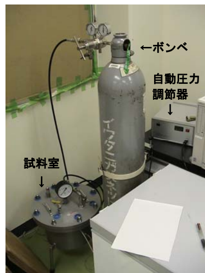
図 1 加圧板法の測器一式
